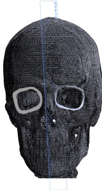
Spiegeln und Modellierung eines Flächenmodells in der CAD-Umgebung
