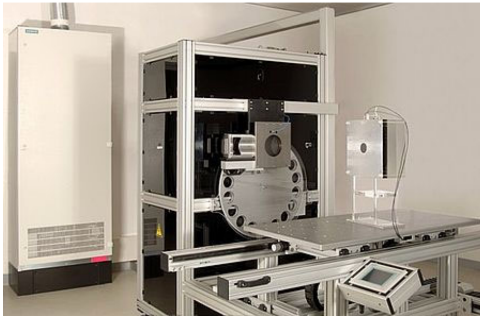
Abbildung 16: Röntgenanlage zur Erzeugung gepulster Strahlungsfelder mit dem Filtrerrad und dem Prüfstand für die Messsysteme [27].
