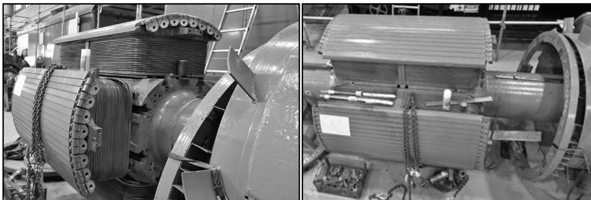
Abb. 3.16: Rotor eines Einphasengenerators mit Dämpferstäben und Längs- und Querdämpferwicklung [Quelle: Trafikverket, Niklas Biedermann]
