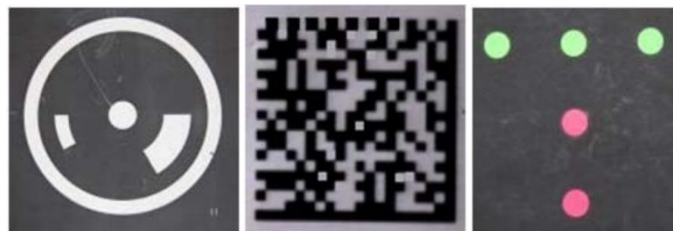
Abbildung 3.4. Drei Beispiele für Indoor Positioning Marker (Mautz, 2012 [16, S. 37]). In der Mitte befindet sich ein QR Code 14
