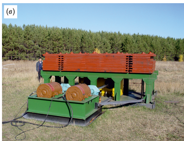
Рис. 1. Схема вибросейсмических исследований в Алтае-Саянском регионе (а) и используемые виброисточники ЦВ-100 (б) и ЦВ-40 (е).
