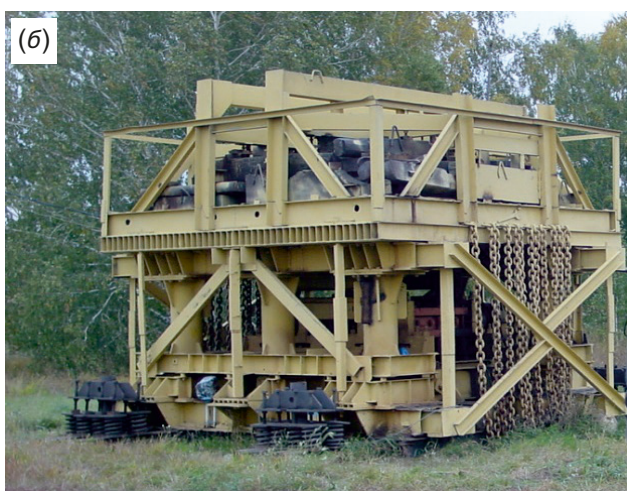
Рис. 1. Схема вибросейсмических исследований в Алтае-Саянском регионе (а) и используемые виброисточники ЦВ-100 (б) и ЦВ-40 (е).
