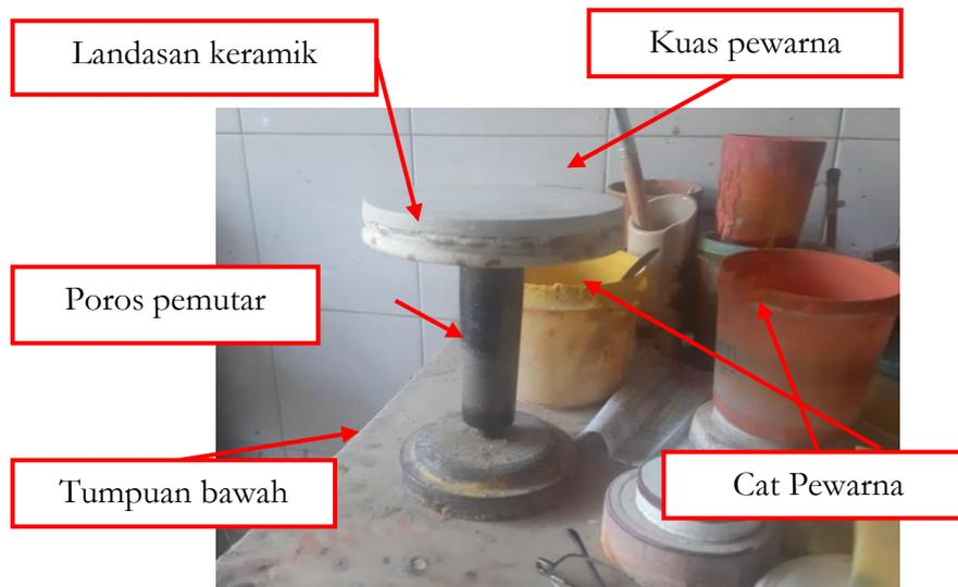
Gambar 2. Mesin Pemutar sederhana untuk proses pewarnaan di UMKM
