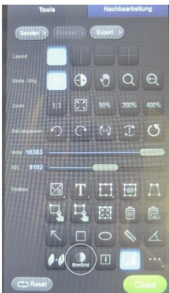
**Abbildung 12: Ausschnitt des Displays des GM85 zur Nachbearbeitung der Röntgenbilder; hier für SG (weiße Markierung)**
