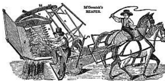
Slika 6: Stroj Cyrusa McCormicka brez Atkinsovega dodatka
