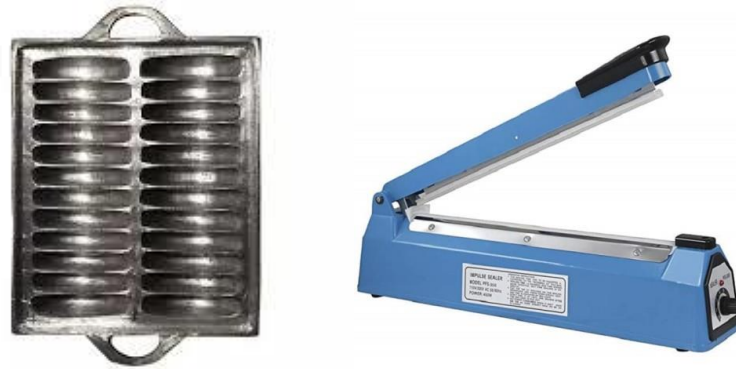
Gambar 3. Cetakan Gandos Besar (kiri) dan Sealer Plastik (kanan)
