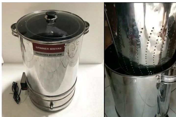
Gambar 4. Spinner tampak luar (kiri) dan keranjang/bagian dalam spinner (kanan)
