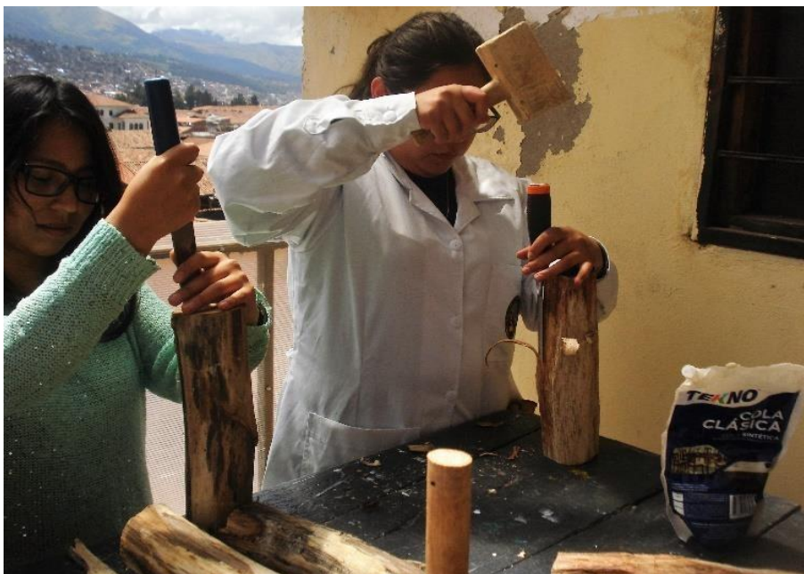
Foto 2. Limpieza de la corteza del maguey para realizar el esqueleto armazón
