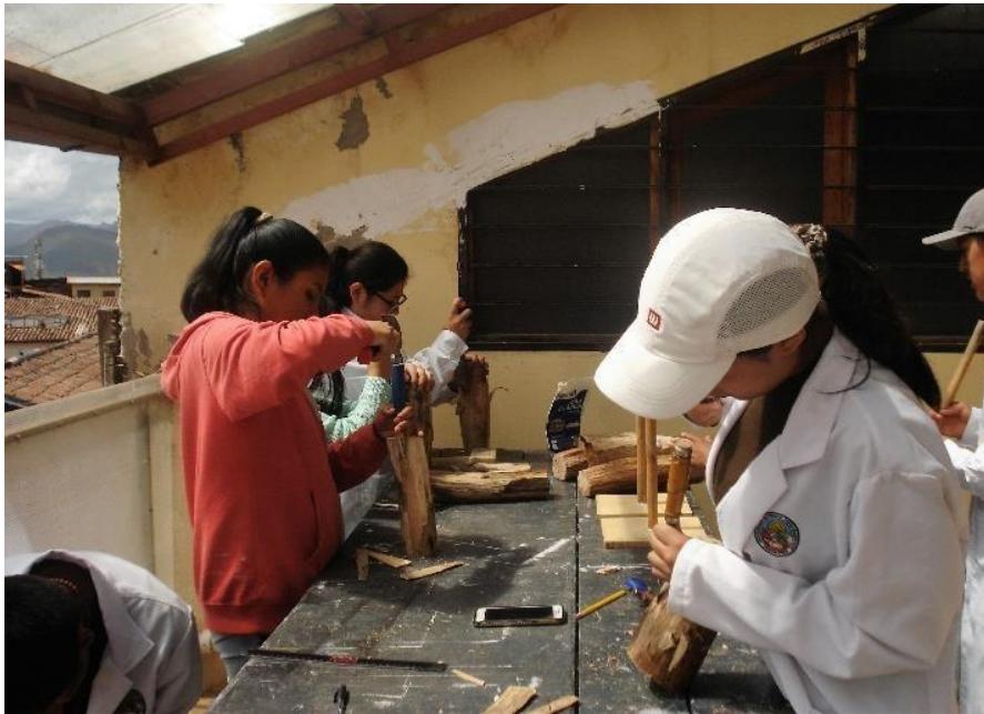
Foto 1. Preparación y limpieza de la madera maguey para el esqueleto armazón
