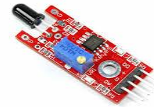
Gambar 5. Sensor Api KY-026 (Sumber : www.arduino.cc )
