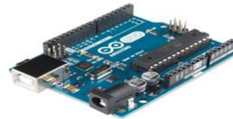
Gambar 1. Arduino UNO (Sumber : www.arduino.cc )
