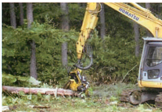
a. 伐倒、枝払い、玉切りを一台でこなす高性能林業機械（北海道富良野市にて）
