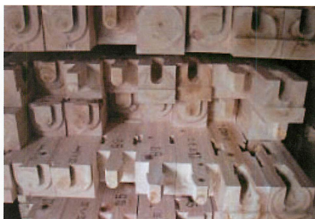
b. 精巧に継ぎ手が加工されるプレカット技術（埼玉県秩父市にて）
