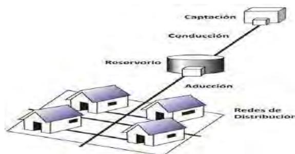
**IMAGEN N°03.**Esquema del sistema de abastecimiento de agua potable.
