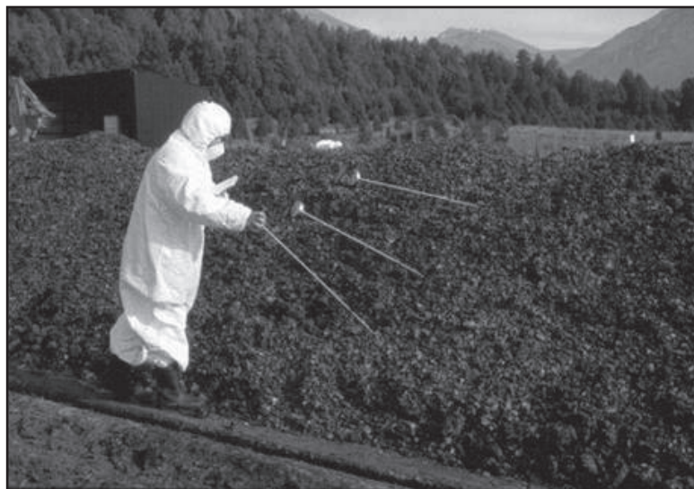
■ Mediciones de temperatura en pilas de compost de biosólidos. El correcto control de la temperatura y humedad de las pilas de compost facilita la obtención de un producto con mejor calidad.
