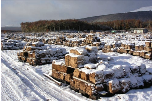
Bloques de turba en secado durante el invierno. La extracción se realiza entre septiembre y mayo.
