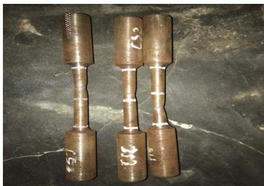
Gambar 10. Spesimen Carbon Steel Setelah Pengujian
