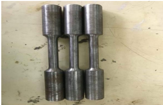
Gambar 8. Spesimen Carbon Steel Sebelum Pengujian
