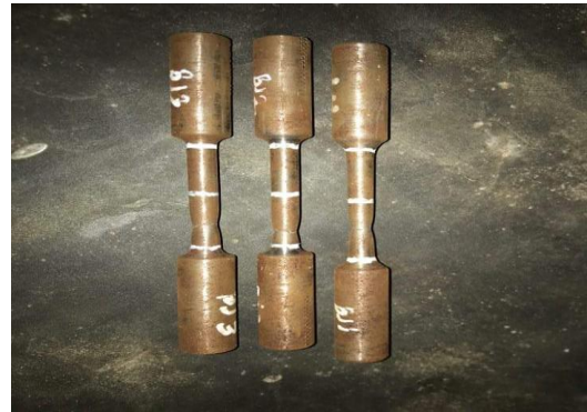
Gambar 11. Spesimen BJTP Setelah Pengujian
