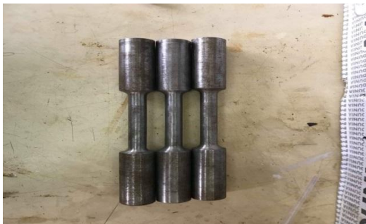
Gambar 9. Spesimen BJTP Sebelum Pengujian
