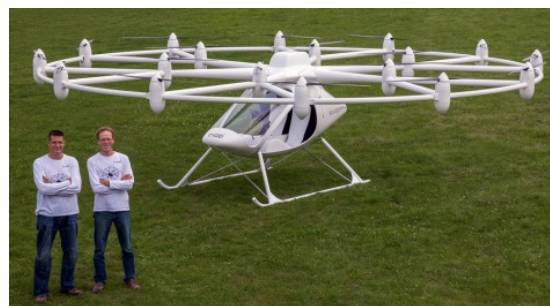
Рис. 4. Восемнадцативинтовой мультикоптер Fig. 4. Eighteen-rotor multi-rotor design
