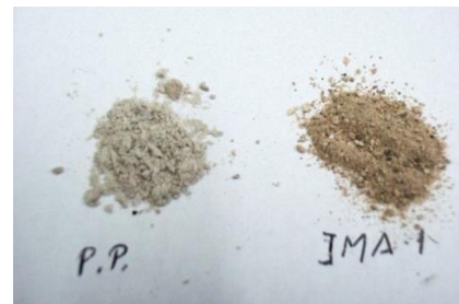
Figura 2: Muestras trituradas de la piedra pómez (PP) y la pomeca puzolánica (IMA – 1). Fuente: Elaboración Propia.
