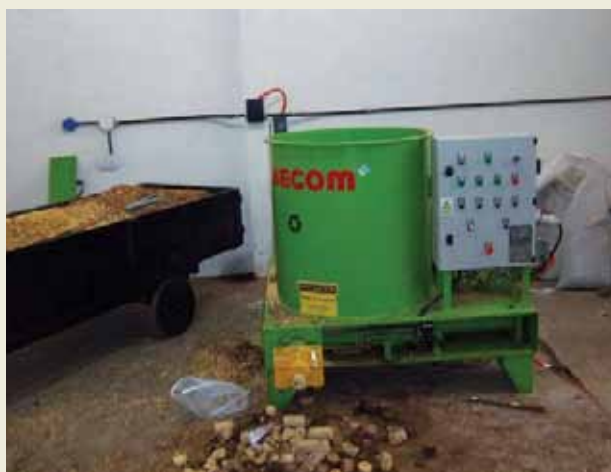
Máquina pelletizadora instalada en el Complejo Tecnológico Productivo de Biomasa Presidencia de la Plaza.
