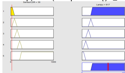
Gambar 7. Fuzzy Set untuk input Sensor LDR Gelap dan Output Lampu dalam keadaan cahaya Sangat Terang
