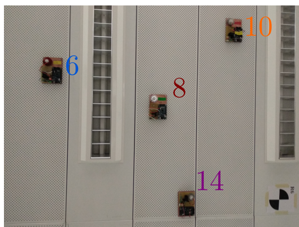
Figura 7.2: Emisores usados. Vista de su colocación en el techo del laboratorio.
