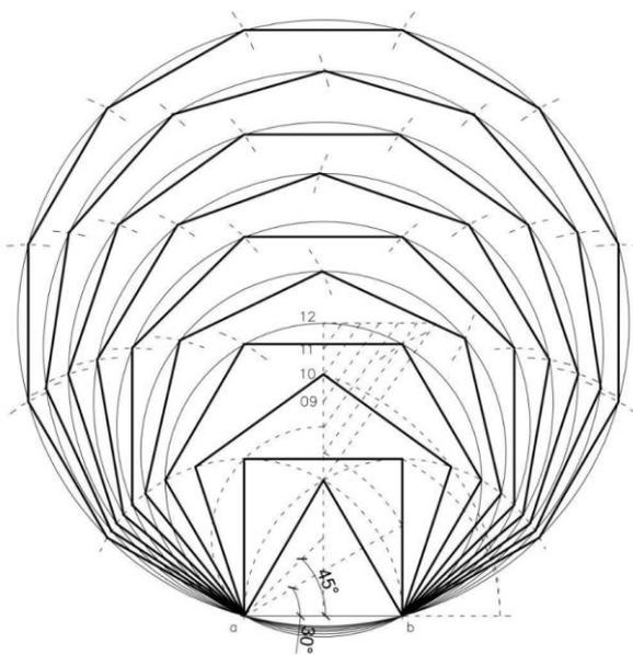
*Figura 35: Construcción de polígonos hasta 12 lados que comparten el lado  $\overline{ab}$ . Recuperado de <https://www.10endibujo.com/poligonos-regulares-lado/>*
