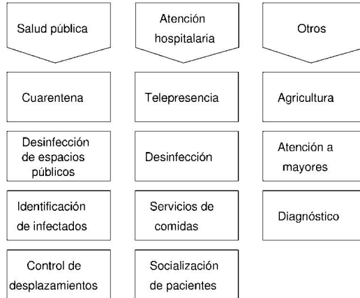
Figura 1. Taxonomía de los robots en función de su campo de aplicación aplicados a la COVID-19.
