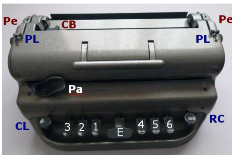
Fig.2. Elementos de una máquina Perkins (Gil, n. d.).
