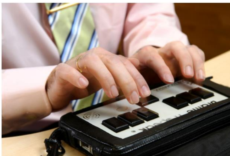
Fig.4. El Braille hablado o Braille'n Speak. ONCE.
