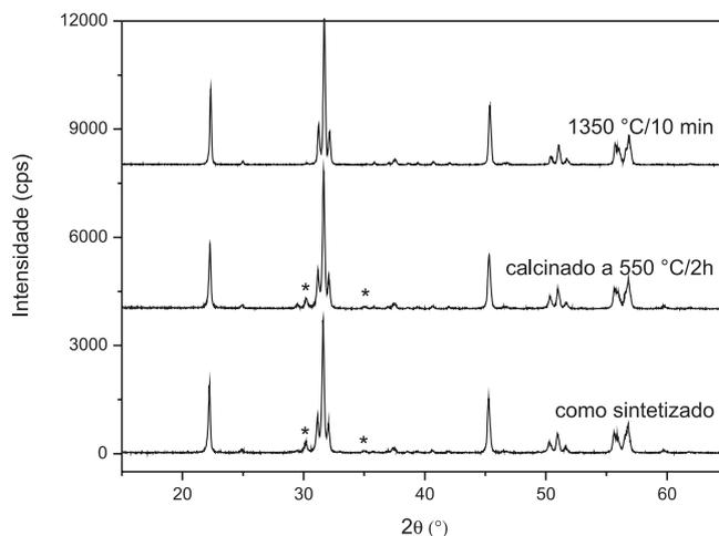
**Figura 1.** Difratogramas de raios X da amostra de  $\text{CaZrO}_3$  como sintetizada, calcinada a  $550^\circ\text{C}$  e tratada termicamente a  $1350^\circ\text{C}$ . Note que a amostra tratada termicamente a  $1350^\circ\text{C}$  é praticamente monofásica, tendo sido eliminada a fase cúbica do  $\text{CaZrO}_3$ .
