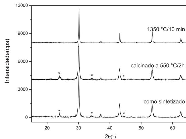
**Figura 2.** Difratogramas de raios X da amostra de  $\text{BaZrO}_3$  como sintetizada, calcinada a  $550^\circ\text{C}$  e tratada termicamente a  $1350^\circ\text{C}$ . Note que a amostra tratada termicamente a  $1350^\circ\text{C}$  é monofásica, tendo sido completamente eliminada(s) a(s) fase(s) não identificada(s).
