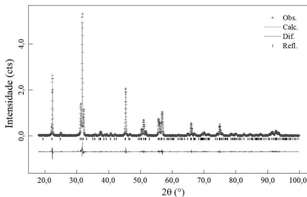
**Figura 3.** Difratoograma experimental (cruzes), ajuste calculado pelo programa GSAS (linha) e a diferença entre os difratogramas experimental e calculado (linha inferior) para o pó cerâmico de  $\text{CaZrO}_3$  tratado termicamente a  $1350^\circ\text{C}$
