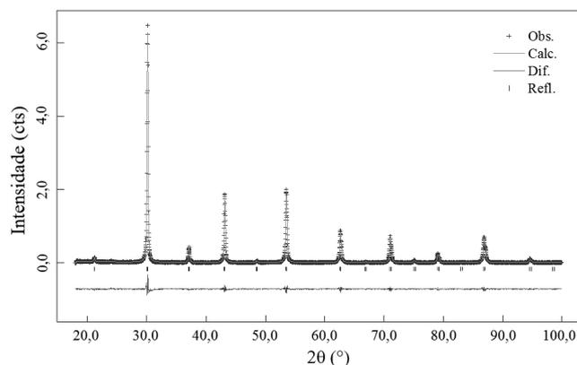
**Figura 4.** Difratoograma experimental (cruzes), ajuste calculado pelo programa GSAS (linha) e a diferença entre os difratogramas experimental e calculado (linha inferior) para o pó cerâmico de  $\text{BaZrO}_3$  tratado termicamente a  $1350^\circ\text{C}$
