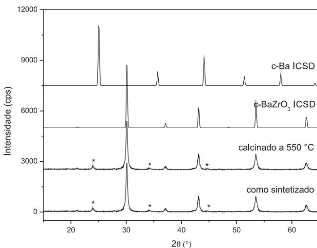
**Figura 2S.** Difratogramas de raios X das amostras de  $\text{BaZrO}_3$  como sintetizada e calcinada a  $550\text{ }^\circ\text{C}$ . Os asteriscos indicam os picos referentes à fase ortorrômbica do  $\text{BaCO}_3$ , enquanto que os demais picos são da fase cúbica do  $\text{BaZrO}_3$ . Os difratogramas dos padrões, conforme cartões presentes na base de dados do ICSD, são também ilustrados na figura
