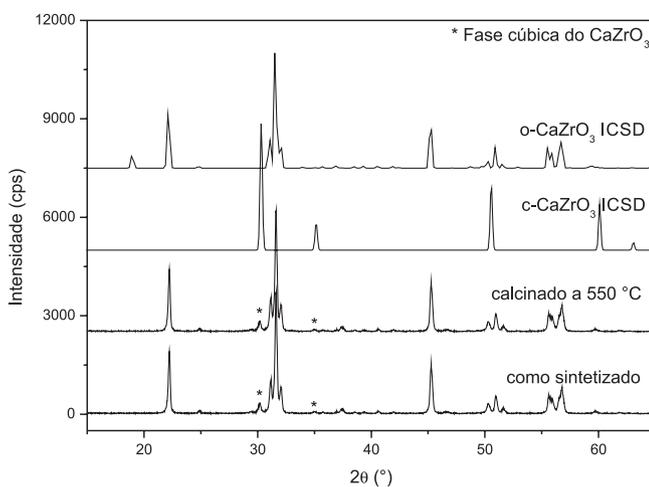
**Figura 1S.** Difratogramas de raios X das amostras de  $\text{CaZrO}_3$  como sintetizada e calcinada a  $550\text{ }^\circ\text{C}$ . Os asteriscos indicam picos da fase cúbica do  $\text{CaZrO}_3$ , enquanto que os demais picos são da fase ortorrômbica majoritária. Os difratogramas dos padrões, conforme cartões presentes na base de dados do ICSD, são também ilustrados na figura
