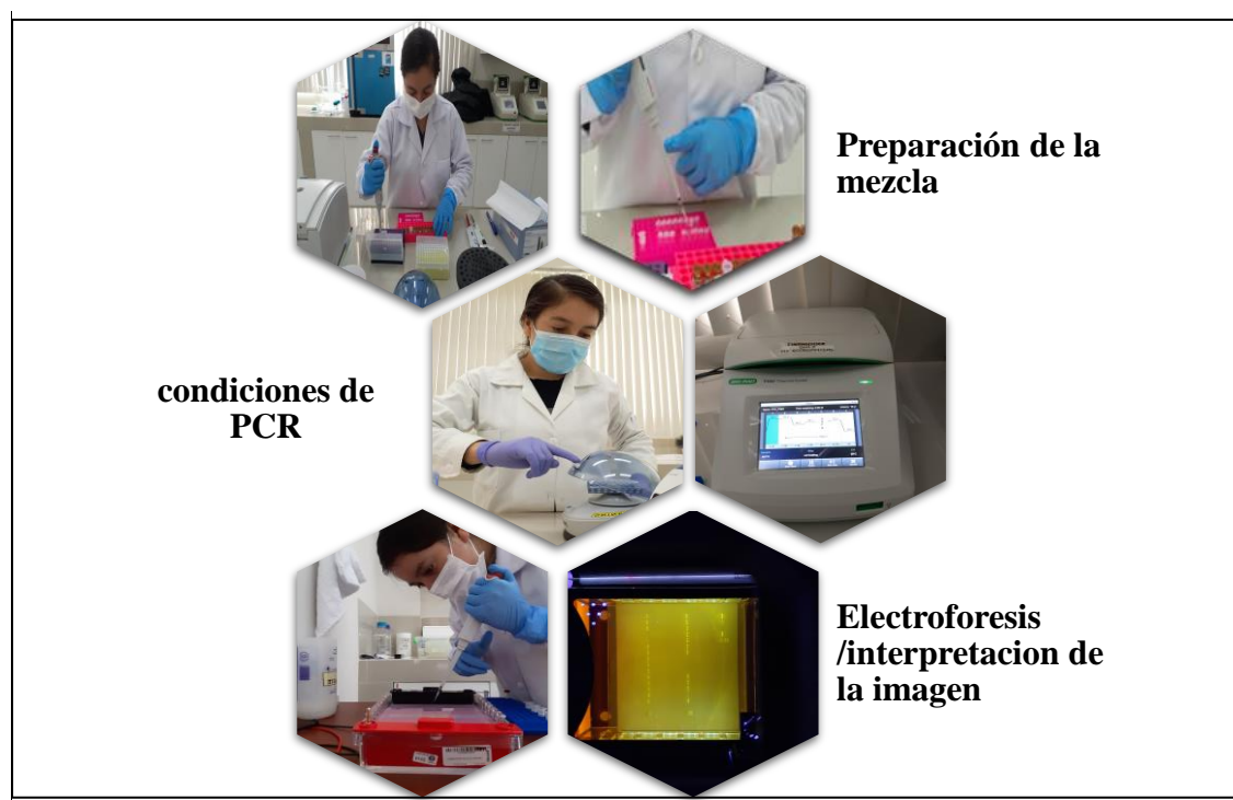
Figura 4. Protocolo de amplificación de los amplicones de los marcadores plastidiales rbcL y trnH-psbA de Poáceas.
