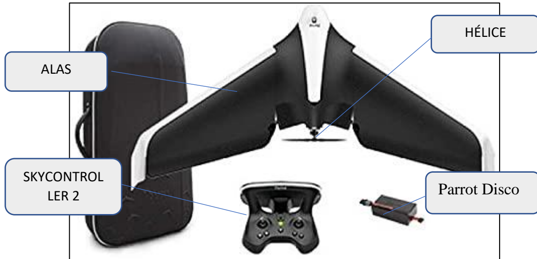
Figura 6. Partes del Dron usado para toma de imágenes multispectrales para determinación de firma espectrales de Poaceae en la ACP Tilacancha.
