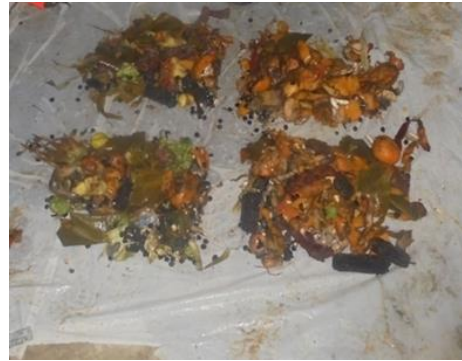
Fotografía 30. Método del cuarteo
