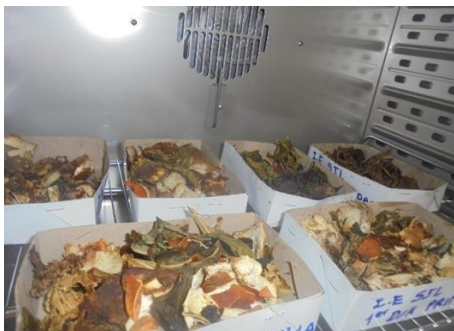
Fotografía 34. Secado de los residuos sólidos en la estufa
