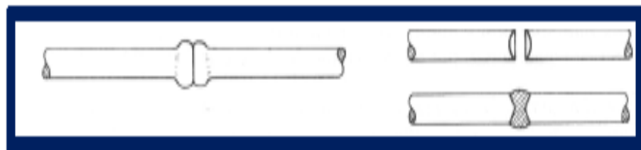
Figura 10. Empalmes por soldadura.
