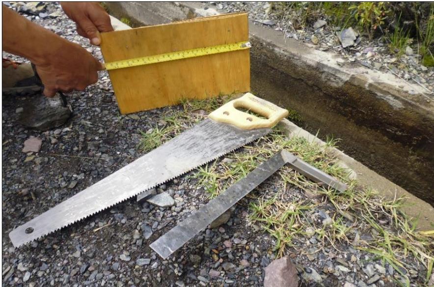
En la figura se muestra la preparación del vertedero para la medición del caudal de acuerdo a la ecuación de Francis. Elaboración propia-foto recopilación de datos.
