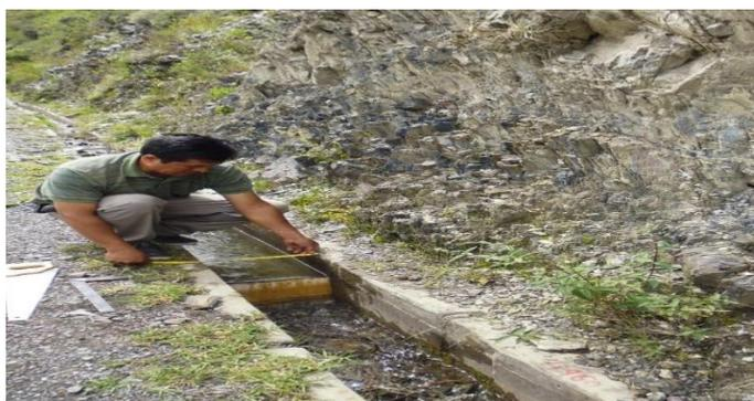
Nota: En la figura se muestra al investigador tomando las medidas del caudal del canal de irrigación. Elaboración propia-foto recopilación de datos.
