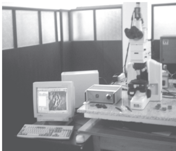
FIG. 2. MICROSCOPIO CON OBJETIVOS INTERFEROMÉTRICOS TIPO MIRAUI
