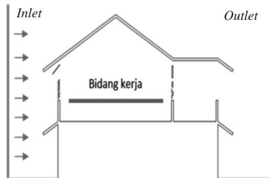
Gambar 10. Letak inlet dan outlet pada potongan vertikal.
