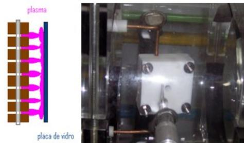
Figura 4: Placa de vidro sendo tratada pelo plasma e este dispositivo inserido na câmara de descarga.
