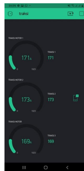
Gambar 4.1 Tampilan saat pembacaan sensor arus
