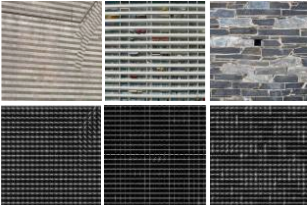
Figura 33. En la fila superior las 3 imágenes tipificadas en el aspecto-LE7 con mayor probabilidad y en la fila inferior las mismas imágenes procesadas con la función HOG.
