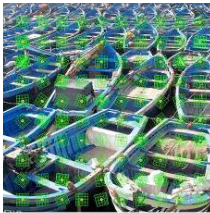
Figura 39. Imagen con una malla de 10 x 10. Los nodos contienen los valores de las 8 orientaciones de los histogramas 4x4. Para cada nodo resulta un vector de características, con 4 \times 4 \times 8 = 128 elementos
