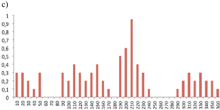
Figura 37. a) Keypoint. b) Región de 16x16 píxeles alrededor del keypoint y gradiente. c) Histograma de orientaciones. La orientación del keypoint corresponde al valor máximo.
