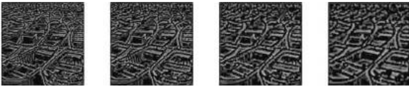
Figura 35. Imágenes-resta de una primera octava. La pirámide DoG se completa obteniendo las imágenes-resta de las sucesivas octavas.
