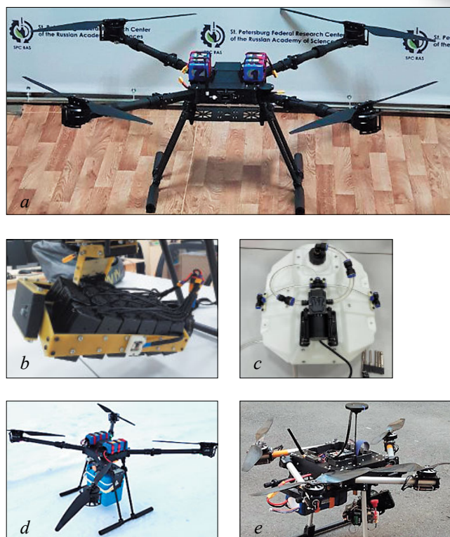
Рис. 3. Серийно выпускаемые БВС и навесное оборудование: а – пример БВС; б – лазерный блок для стимуляции растений; с – система полива; д – захват для транспортировки грузов; е – бортовая видеокamera
