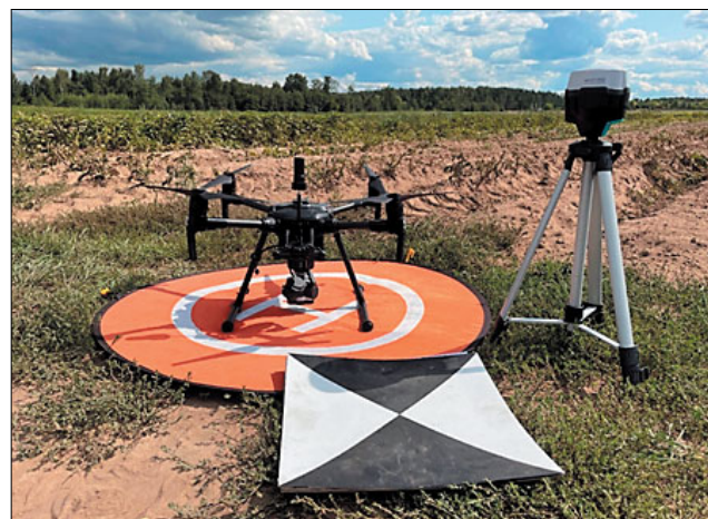
Рис. 1. Платформенное решение для высокоточного мониторинга сельскохозяйственных полей (слева направо): беспилотное воздушное судно DJI Matrice 200 v2 с GNSS -приемником, контрольная точка, мультичастотный GNSS -приемник EMLID Reach RS2 на треноге
