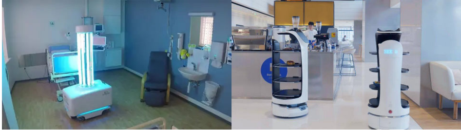
Figura 2. a) Robot móvil para desinfección de cuartos hospitalarios; b) robot móvil para transporte de alimentos
