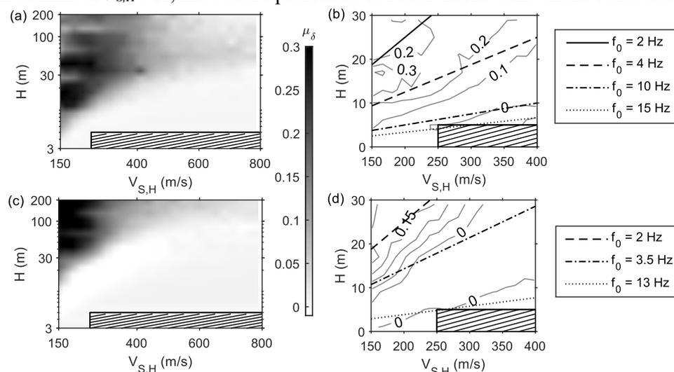
Fig. 2. Andamento di  $\mu_{\delta,X}$  in funzione di  $V_{S,H}$  e  $H$  per SPSA (a-b) e LPSA (c-d). Le figure b-d mostrano in dettaglio l'andamento di  $\mu_{\delta,X}$  (come curve di livello) nella regione rappresentativa dei depositi superficiali e deformabili. La porzione tratteggiata non è stata oggetto di analisi.
