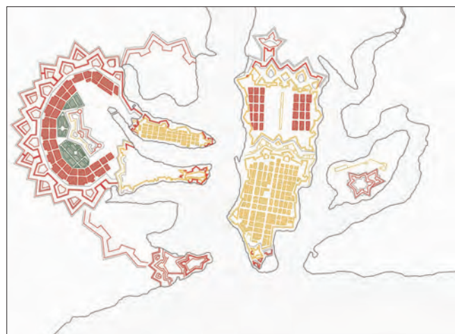
Fig. 5. Elaborazione di I. Maniscalco sulla pianta Plan Général de Malte (BL, ADD. MS. 63590 A, n. 127: i tratti rossi per i nuovi inserimenti e gialli per la preesistenza, in verde la progettazione dei giardini)
