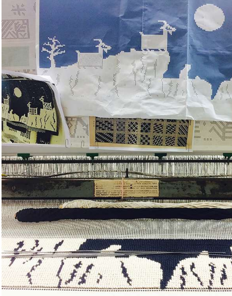
Fig. 20 - Un tappeto con disegno di Maria Lai, in lavorazione presso la Cooperativa Su Marmuri, Ulassai. ben rappresenta la spola, la trama e l'ordito.
