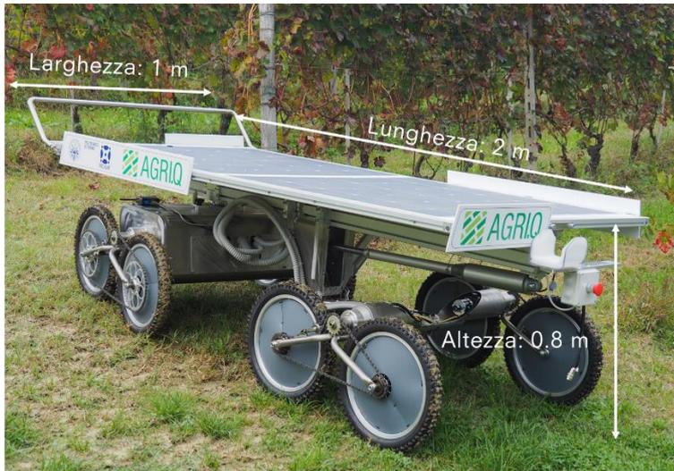
La presenza dei bilancieri sulle unità di locomozione e di un asse di rollio posteriore consentono una corretta distribuzione del carico normale sulle ruote in presenza di irregolarità longitudinali e trasversali.
