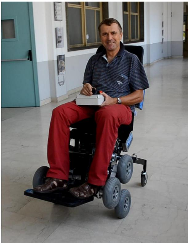
La carrozzina Wheelchair.Q05 (5) è un prototipo realizzato presso il Politecnico di Torino, che utilizza gli approcci tipici della robotica mobile per il riconoscimento degli ostacoli, per la gestione dei sottosistemi di attuazione e governo e per la locomozione.
