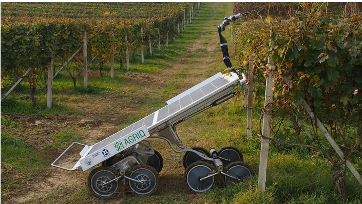
In sintesi l'intero processo di progetto mira alla sostenibilità, consentendo di realizzare tecniche colturali dal minor impatto ambientale, implementando il concetto di risparmio energetico tramite la minimizzazione del peso e l'efficienza del sistema di locomozione, utilizzando per quanto possibile energie rinnovabili per il funzionamento del sistema, liberando l'uomo dalle attività ripetitive di monitoraggio, e lasciando quindi ad esso le funzioni di gestione e decisione.
