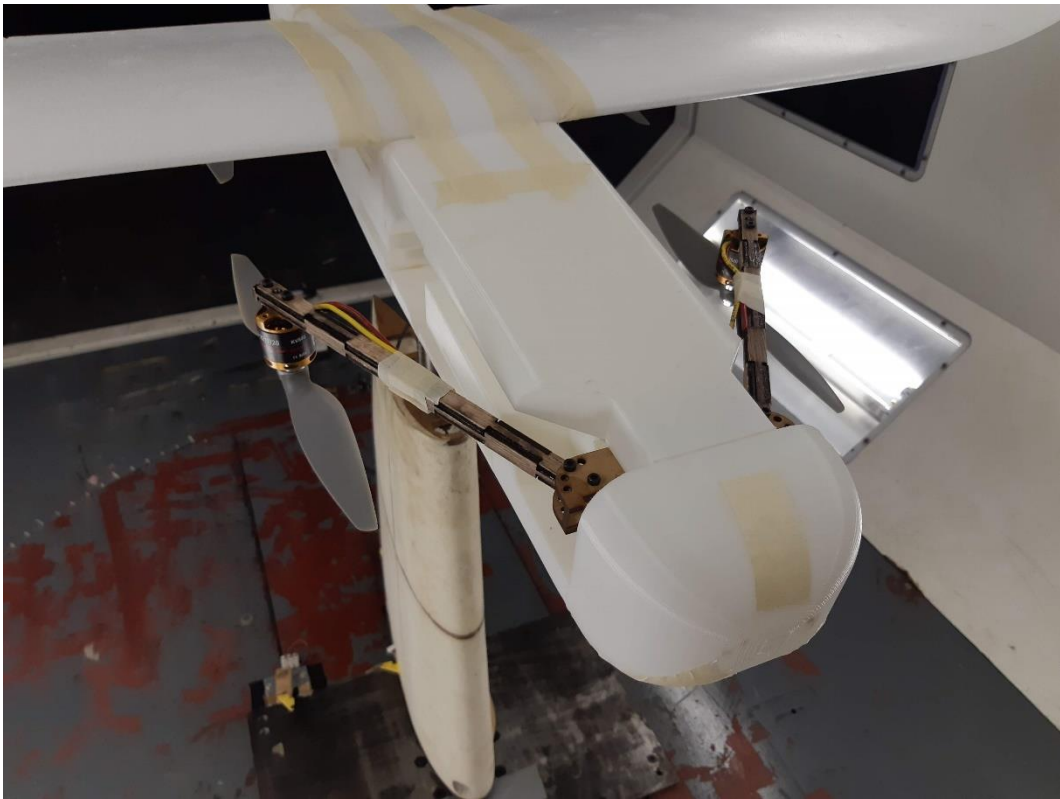
Figure 109: Mini Talon 2, propellers out 30°.
