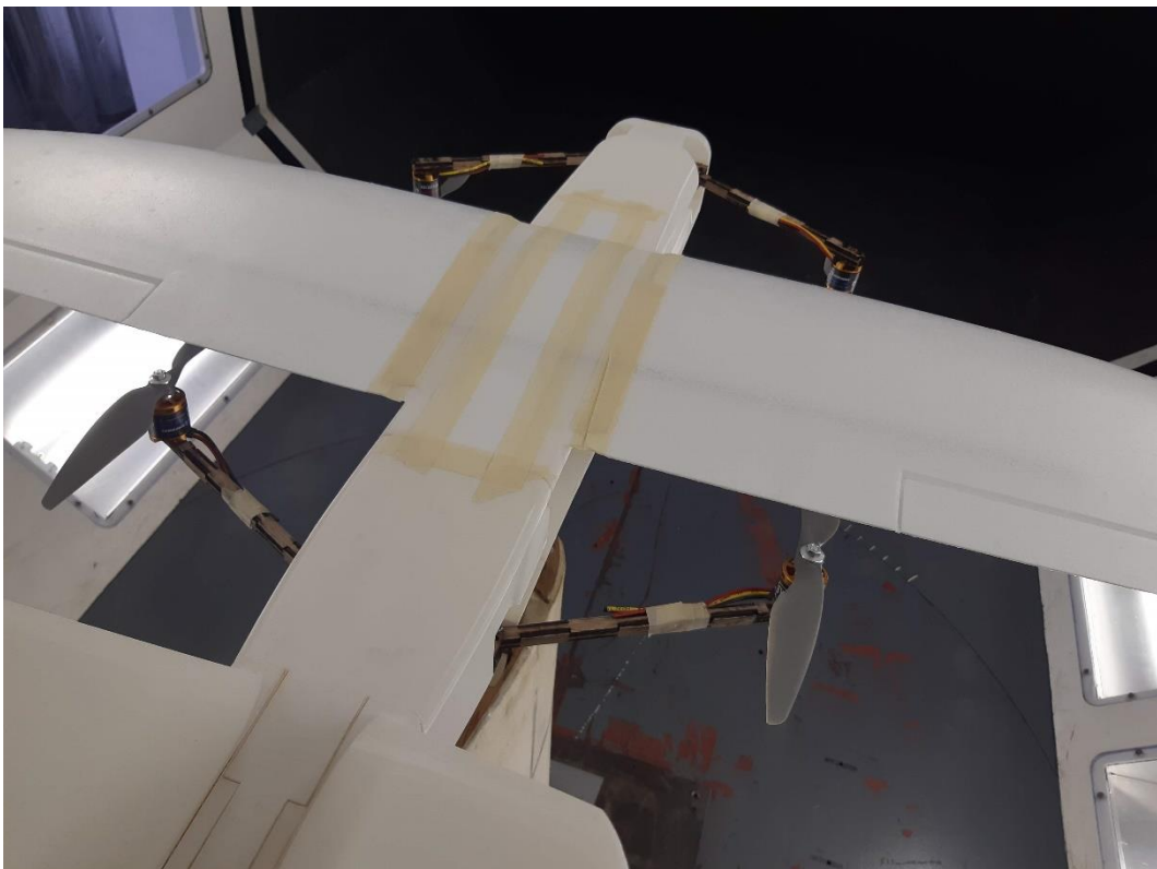
Figure 110: Mini Talon 2, propellers out 60°.
