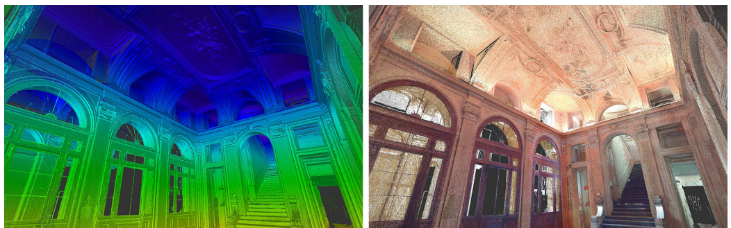
Fig. 7. Nuvola di punti e nuvola di punti texturizzata di Palazzo Galleani di Canelli e di Barbaresco (scansione di María Concepción López González; allineamento di Fabrizio Natta).
