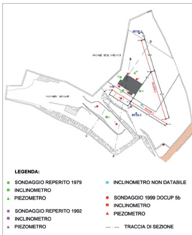
Figura 18. Planimetria del piazzale della Torre degli Smeducci. Nel dettaglio: disposizione stendimenti MASW-1 e MASW-2 e punti di acquisizione prove HVSR-2 e HVSR-3 distribuite sull'area di indagine.
