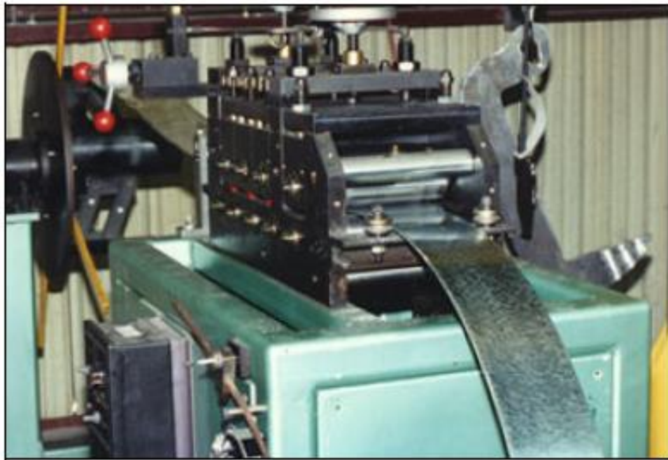
Figura 2.10. Rodillos enderezadores de chapa (Arias, 2004)
