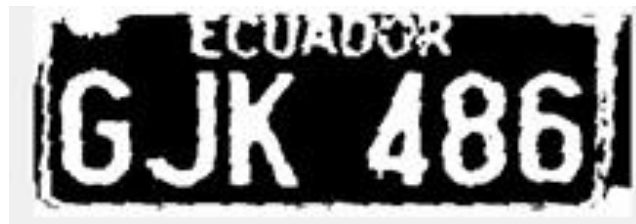
Fig23 - Binarización de la placa vehicular Fuente: Elaboración propia
