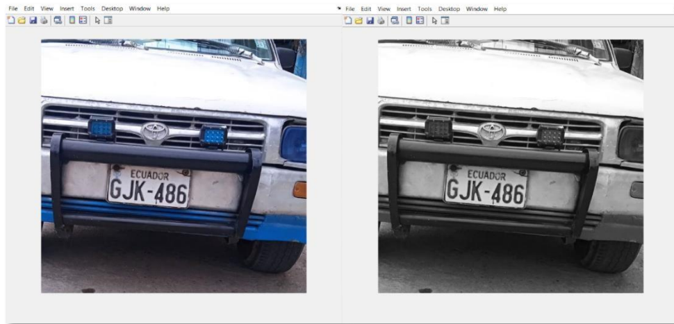
(1) (2) Fig20 - (a) Imagen en formato RGB (b) Imagen convertido a escala de grises Fuente: Elaboración propia
