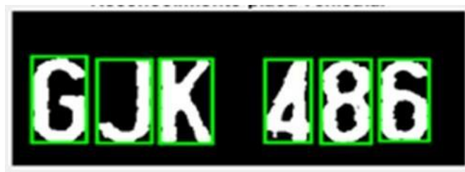
Fig25- Segmentación de la placa vehicular Fuente: Elaboración propia
