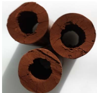
Abbildung 16: Nichtkalzinierte Rohre aus 75 Ma.-% Nickelferrit mit einem Durchmesser von 25 mm
