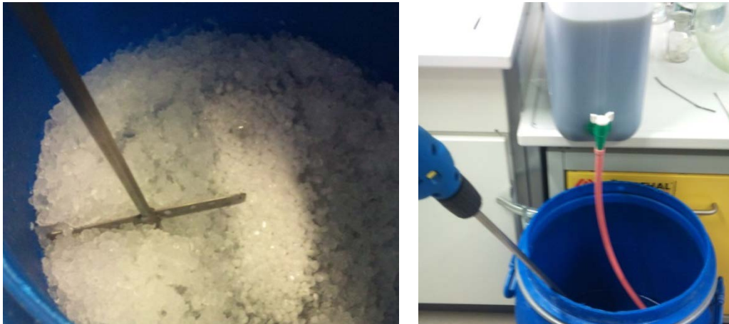
Abbildung 11: Herstellung der 20 L Natronlauge mit Eis aus destilliertem Wasser (li.) und Zugabe der Nickel- und Eisennitrat-Lösung zur Fällung der Metallhydroxide (re.)
