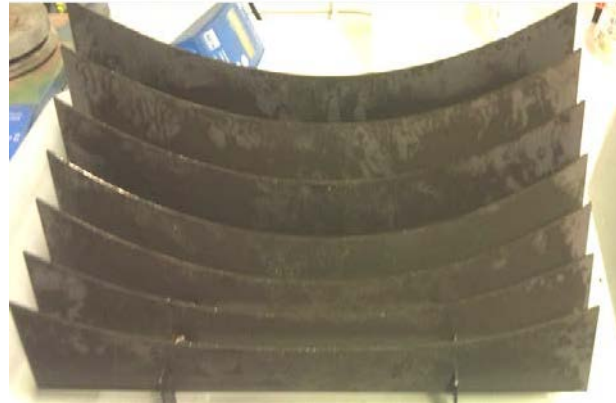
Abbildung 18: Brüniertes TwinFire-Gate nach der Beschichtung mit Nickelnitrat-Lösung
