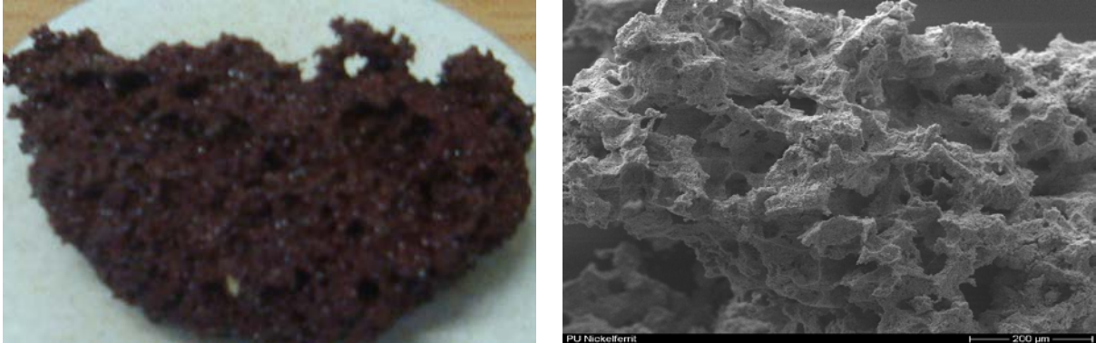
Abbildung 8: Probe aus Nickelferrit durch Aufschäumung von PU erhalten
