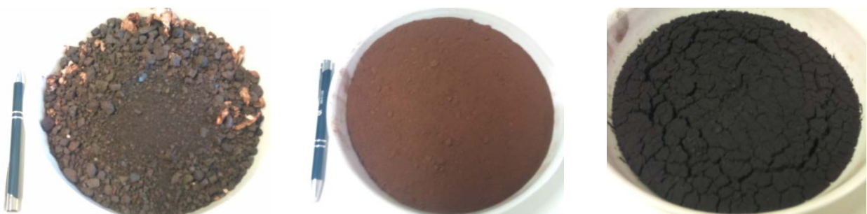
Abbildung 13: Getrocknete Metallhydroxid-Mischung (li.) nach dem Mahlen (mi.) und als kalziniertes Pulver (re.)
