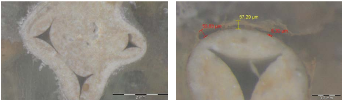
Abbildung 21: Lichtmikroskopische Aufnahmen vom Querschnitt des gealterten Wandkatalysators
