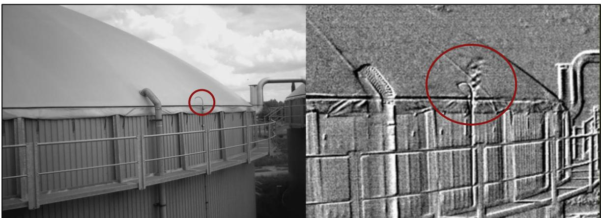
Abbildung 5-3: Methanemission aus einer Leckage an der Anzeige für den Biogasfüllstand
