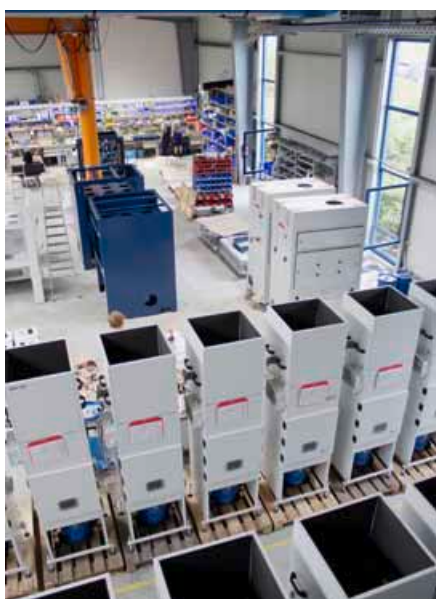
In der Abteilung Großgerätefertigung stellen Mitarbeiter der ULT AG Absaug- und Filtergeräte für Industrie und Handwerk her.
