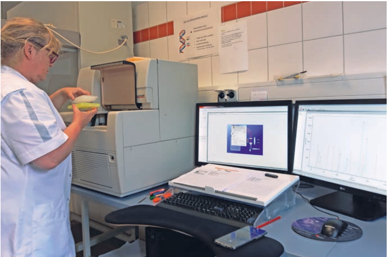
Abb. 42: Fragmentlängenbestimmung von Mikrosatelliten-Markern im DNA-Labor
