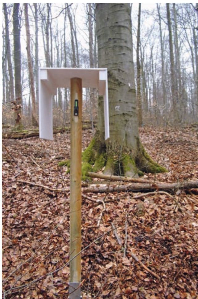
Abb. 41: Datenlogger zur kontinuierlichen Erfassung von Temperatur und Luftfeuchte in der Monitoringfläche
